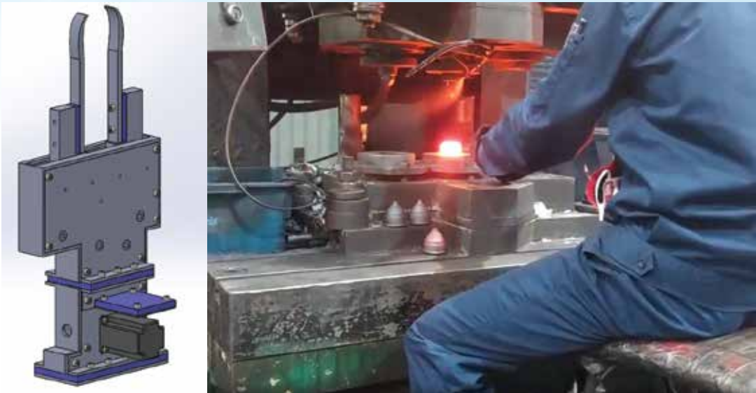
Hình 3: Bàn tay robot phục vụ máy rèn dập nóng thiết kế và chế tạo bởi bộ môn Cơ điện tử TNUT
