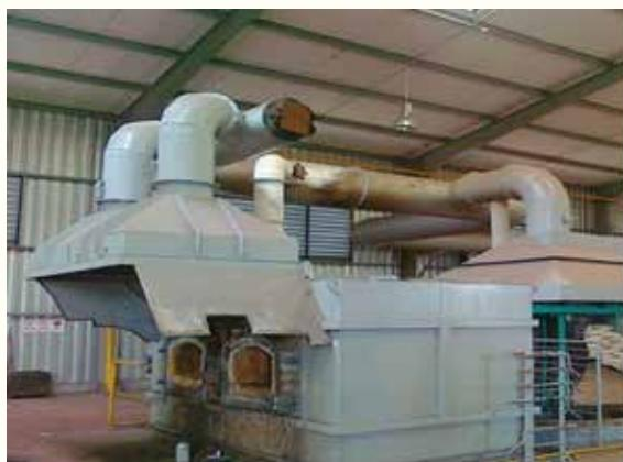
Hình 2: Hệ thống hút bụi, hồi liệu
